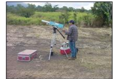
Personal técnico de la Unidad de Investigación y Servicios Vulcanológicos del INSIVUMEH, realizando mediciones de COSPEC en las lutas del Volcán de Fuego
